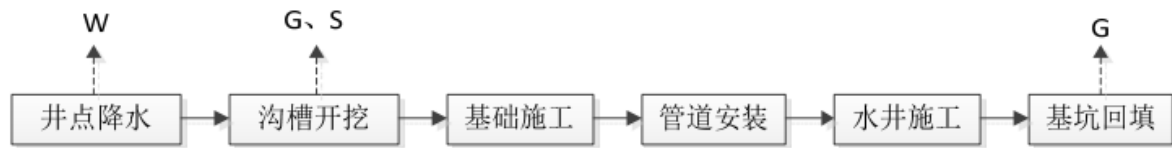
图 8.1-5 管线工程施工基本工艺流程图
