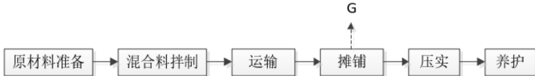
图 8.1-3 路面沥青摊铺施工基本工艺流程图
