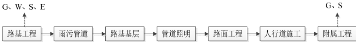
图 8.1-1 道路施工基本工艺流程图
