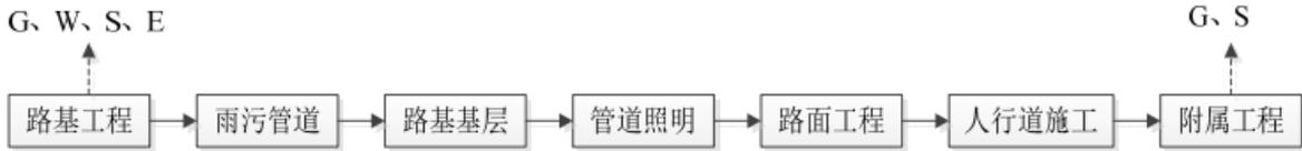
图 8.1-1 道路施工基本工艺流程图
