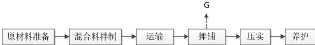
图 8.1-3 路面沥青摊铺施工基本工艺流程图
