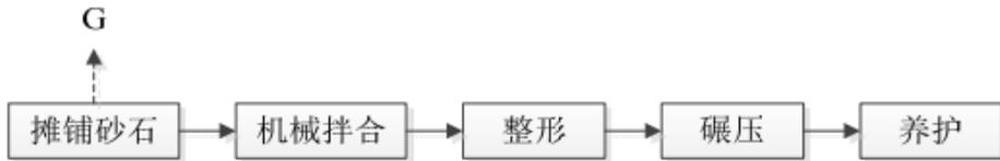
图 8.1-2 路面基层施工基本工艺流程图
