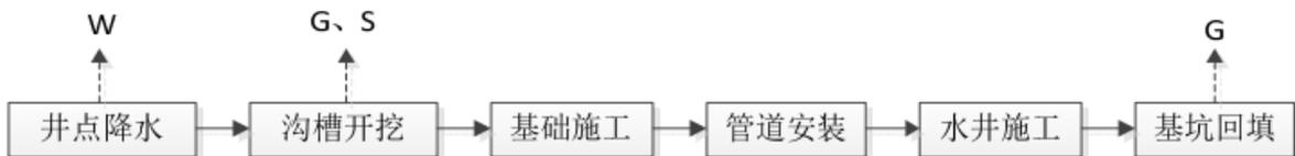
图 8.1-5 管线工程施工基本工艺流程图
