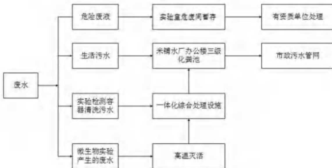
图 3-1 项目废水处理流程示意图
