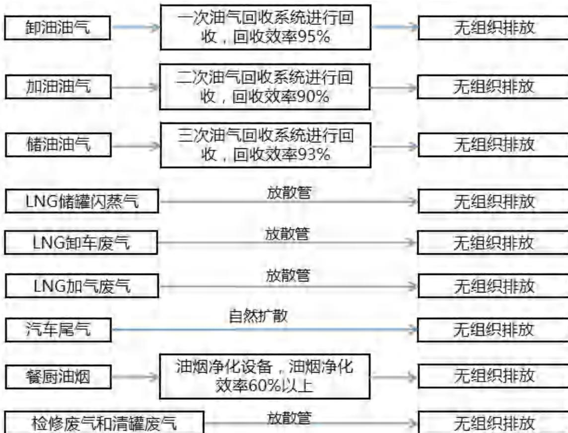
图 3-3 项目废气处理流程示意图
